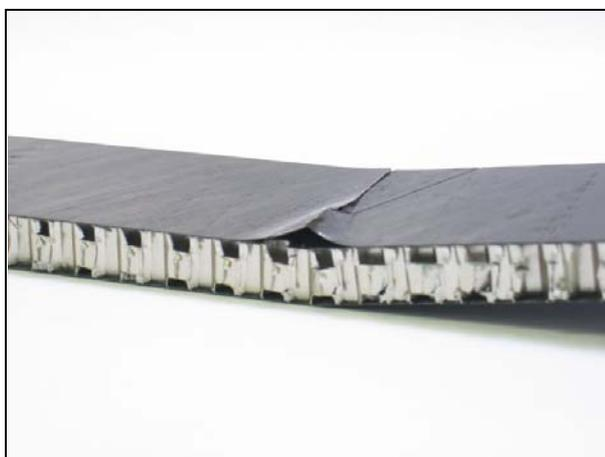
**Figura 12:** Prove di fatica: rottura nel provino integro
